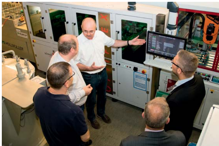
Innenlagenstanze Optiflex II zur Leiterplatten- und Multilayerfertigung im Werk Rohde & Schwarz in typischer Produktionsumgebung
