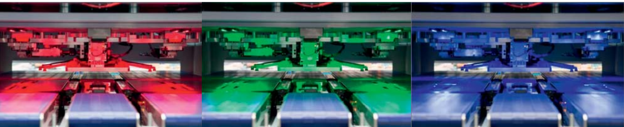
Das RGB-Ringlicht der Innenlagenstanze Optiflex II erkennt die Messmarken auf den verschiedenen Panel-Oberflächen
